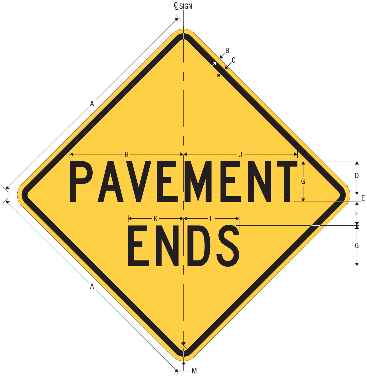
W8-3 PAVEMENT ENDS
